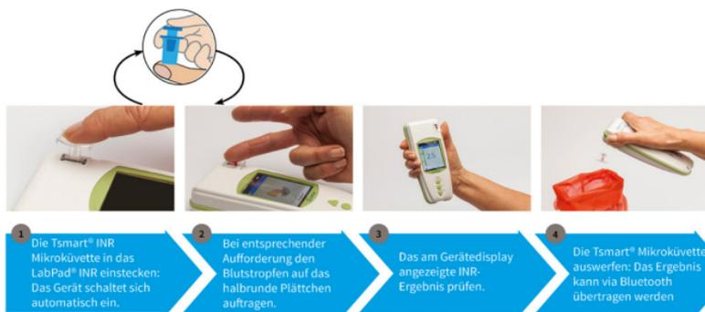
Die Tsmart® INR Einmal-Mikroküvette enthält ein lyophilisiertes Reagenz auf Thromboplastinbasis. Wenn die Blutprobe auf das zuvor in das Gerät eingeschobene Mikroküvettenplättchen getropft wird (siehe Abschnitt 5 Durchführung eines INR-Tests), wird sie durch Kapillarwirkung aufgenommen und mit dem Reagenz vermischt. Zu diesem Zeitpunkt beginnt die Gerinnungsreaktion.
